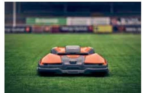
CEORA ist die Lösung für sehr große Flächen bis zu 75.000 m<sup>2</sup>, die mit hervorragender Leistung und Zuverlässigkeit systematisch gemäht werden. Dank EPOS arbeitet Ceora ohne Begrenzungskabel, so lassen sich die Flächen z.B. problemlos aerifizieren. CEORA ist ein zukunftsfähiges modulares System, das für weitere Anbau-Geräte vorbereitet ist.
