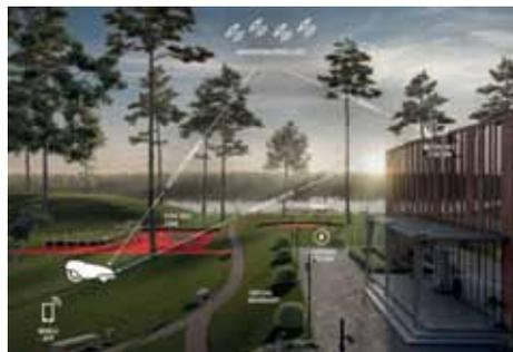
Das Exact Positioning Operating System EPOS ist eine bahnbrechende satellitengestützte Technologie von Husqvarna, die den Einsatz von Mährobotern innerhalb virtueller Grenzen ermöglicht, ohne Begrenzungskabel. Eine flexible Lösung für große Rasenflächen wie Sport- und Golfplätze, Stadien, Parks und Gewerbeflächen. Voraussetzung für EPOS ist ein ausreichend unverbaubarer Blick auf den Himmel.
